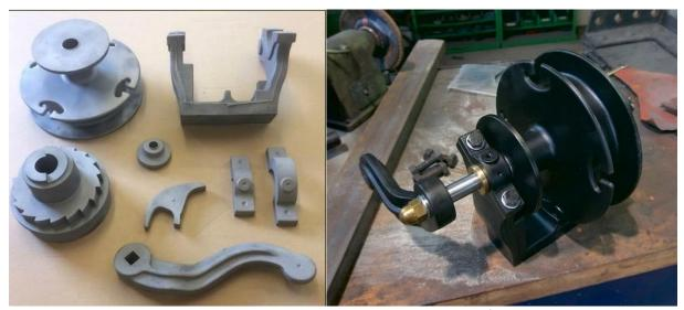
Die Haspel, der ursprünglich vorhandenen Seilzugbremse, wurde nachgefertigt. Hierzu wurden diverse Guss-Modelle konstruiert und gebaut. Foto: Kleinbaan Service B.V.
