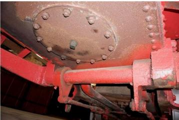
Rechts: Bei der Pflege zur Denkmalszeit wurden leider nur die halbwegs zugänglichen Stellen gestrichen und vor Korrosion geschützt. Inwieweit der Rahmen noch genügend dickes Blech hat, wird erst nach dem Sandstrahlen von innen und außen sichtbar. Foto: Kleinbaan Service B.V. Links: Ein Blick in die Rauchkammer mit den Resten der Gegendruckbremse. Foto: Kleinbaan Service B.V.
