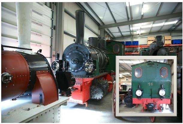
Die Lok steht trocken im Magazin in Veendam. Für die Lok wurden vier große und zwei kleine preußische Loklaternen nachgefertig. Hier die großen Petroleumlampen auf ihren Halterungen an der Lok. Foto: Kleinbaan Service B.V.
