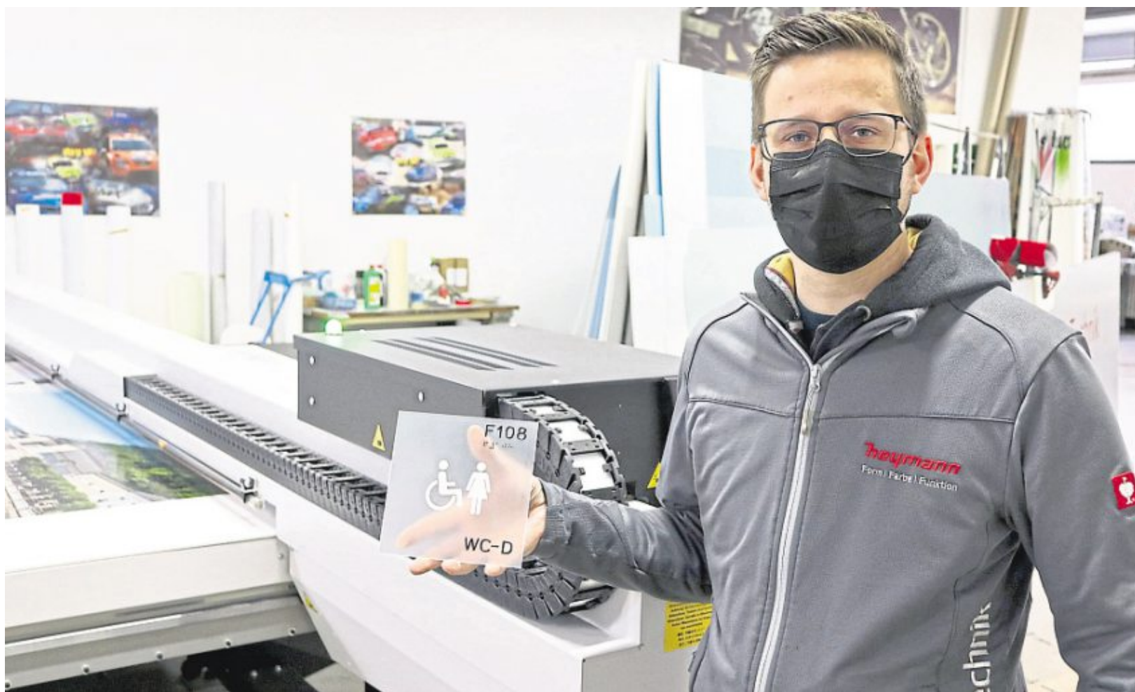
Mit taktilem und Blindenschrift macht dieses von Simon Schmitt präsentierte WC-Schild die Welt ein wenig barriereärmer. Direkt dahinter ist der Druckkopf des Plattendruckers zu sehen.
